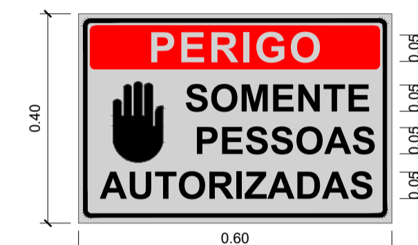
PLACAS DE ADVERTÊNCIA TIPO II Escala: 1:10
