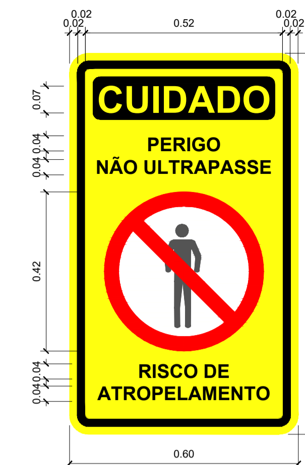
PLACAS DE ADVERTÊNCIA TIPO I Escala: 1:10
