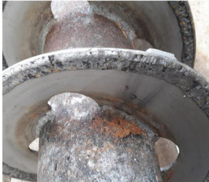
**ETE Recanto das Emas – Rosca central da centrífuga – Perda de material por abrasão ocasionando desbalanceamento e trincas após 20 meses de uso**
