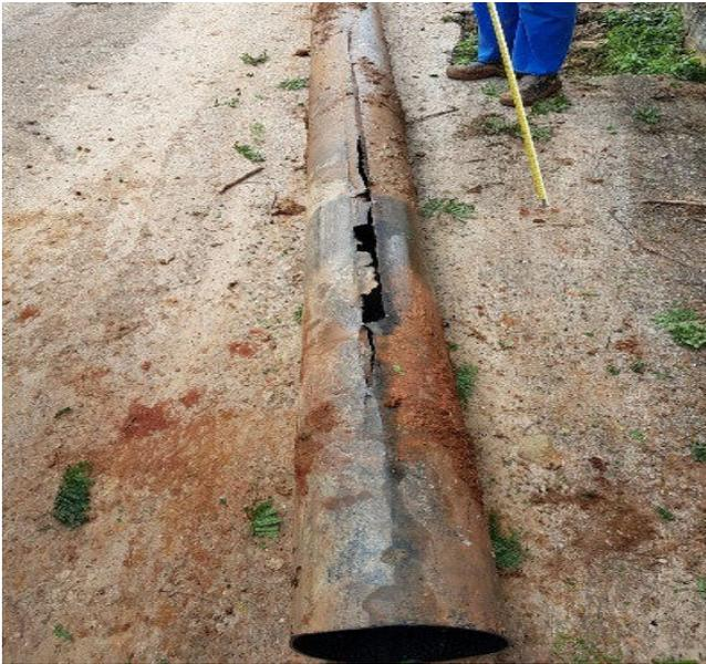
**EEB 09 Lago Sul - Rede de Recalque rompida devido a abrasão.**
